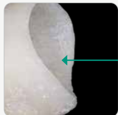
Reaktiokerros: Muotista ja prässäysmateriaalista koostuva hybridikerros
