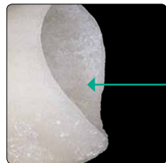
Warstwa reakcyjna. Hybrydowa warstwa powstająca między masą osłaniającą a materiałem do tłoczenia
