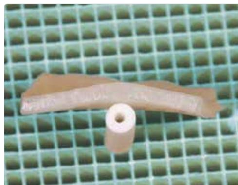
Rezultati nakon 5. pečenja (770°C 1 min, zaustavljanje). Testiranje proveo Masayuki Hoshi, Odeljenje za razvoj i istraživanje.
