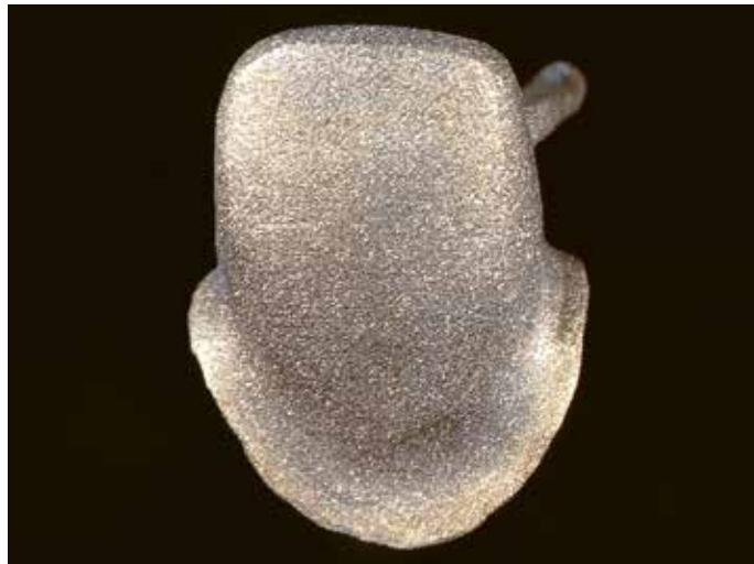
**ES** Las estructuras de metal colado son acabadas con fresas de carburo de tungsteno o instrumentos adecuados para desbastar aleaciones para metalcerámica y oxidadas de acuerdo a las instrucciones del fabricante de la aleación.
