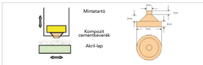
20. ábra: A 3-body kopásállósági vizsgálat felépítése
