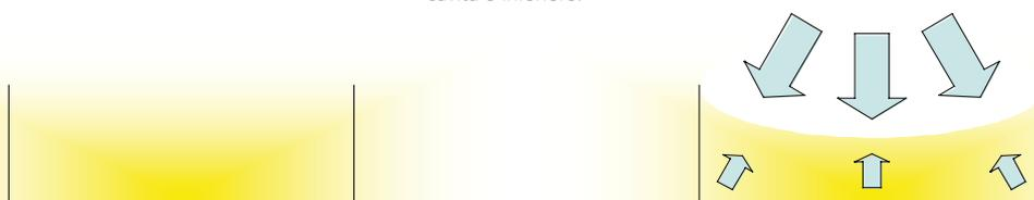
Figura 7b. Compositi con modulo elastico elevato. Si possono deformare solo leggermente durante la polimerizzazione. Lo stress da contrazione si verifica sulla superficie libera e sull'interfaccia composito/dente.
