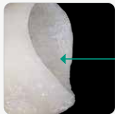
Capa de reacción: Estrato híbrido constituido por el revestimiento y el material de inyección
