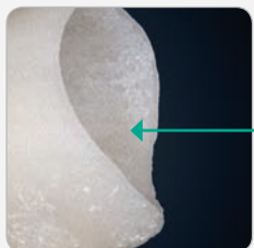
Reakciós réteg: A beágyazóból, és a préskerámiából kialakuló hibrid réteg.
