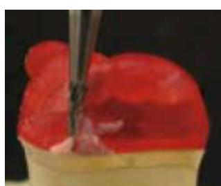
12. Jednakomjerno smanjiti debljinu modela na 0,3-0,4 mm i provjeriti mjerkom. Također provjeriti rubove.
