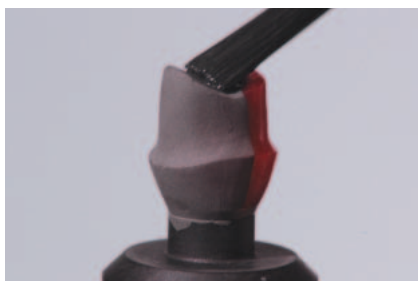
26 スキャニングの際レーザーが読み取りやすいように、ワックスアップ本体表面に専用の黒リキッドを塗布する。
