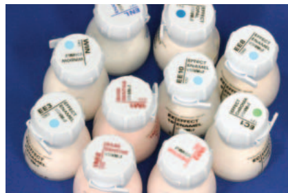
38 インセラム用の新しい陶材パウダー VITA VM7を用いて通法に従って築盛。従来のものより粒子が細かく対合歯に優しい。曲げ強度は20%アップしており、口腔内で安定した材料である。
