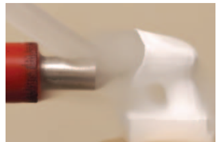
36 GN- I ミリングマシンを使用しているセラミックブロックの加工。注水下で行われ完全自動加工が可能。
