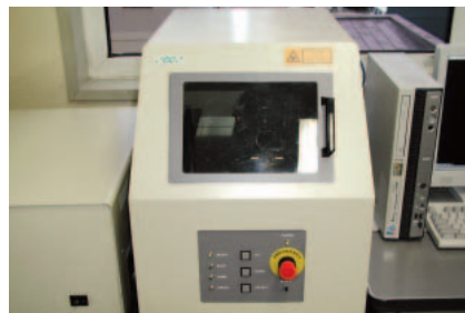
11 レーザー計測機。非接触方式のレーザ ー計測のため、アンダーカットも正確 に測定可能になり、正確な支台歯デー タを作成できる。
