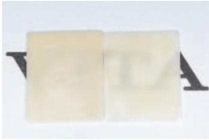
31 アルミナ・スピネルブロックを0.3ミリにスライスし、ランタンガラスを浸透させた試験片、アルミナ(左)、スピネル(右)。
