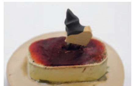
12 レーザー光の乱反射を防ぐため、専用 の黒リキッドを塗布する。
