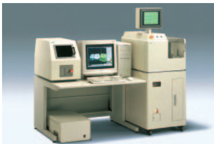
10 GN- I によるコーピング作製。作製者の 経験、技術を問わず高品質な製品が安 定して作製する事ができる。支台歯計 測→PCでの設計→加工機での加工。
