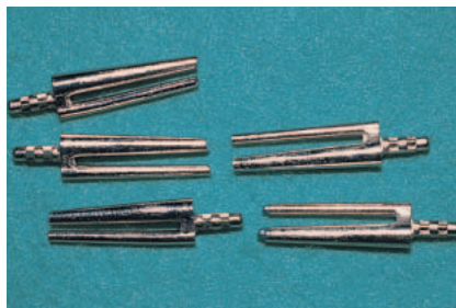
14 二次石膏の膨張率や表面精度が良くないと、使いたいダウエルピンも使えない。
