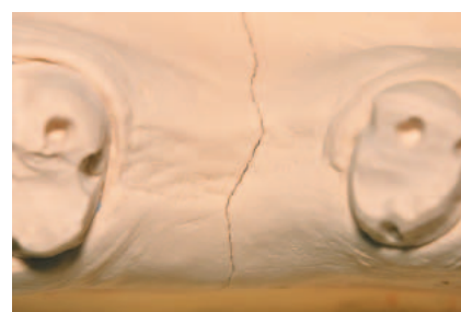
3 分割可撤式作業模型を製作する際に、超硬石膏(一次石膏)に亀裂が入ることを経験した。二次石膏に用いた硬石膏の膨張率が0.25%と大きいことによるものだろう。
