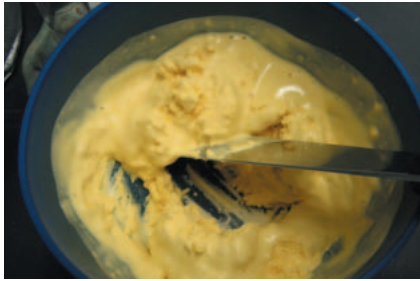
19 石膏の攪拌を比較すると、従来のニュープラストーンは水となじむまで“ぼそぼそ”した感じがある。
