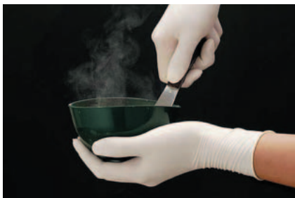
22 従来のニュープラストーンは攪拌初期にパウダーが飛散する。
