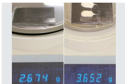
A-4 同じ重さ(約1g)はチューブタイプの約1.5cmに相当する程度に過ぎず、それを上回る利点を考えればカートリッジタイプを薦めたい。
