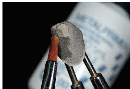
1-11 金属接着性プライマー「メタルプライマーII」を接着面に薄く一層塗布します。塗布後はすぐに揮発しますが、それで十分な接着力が得られます。2、3度と厚塗りをすると逆に接着力が落ちるので注意します。
