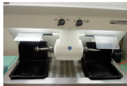
1-39 弊社の研磨はほとんどレーズで行うため、短時間で艶が出て表面性状は残るものが良く、以前のプロシモに比べると研磨時間が短くなり表面性状は残しやすくなった。
