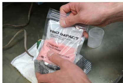
3-8 混和にデンチャーパックを使用することで、液の揮発を防ぎ、操作余裕時間を延ばすことができる。
