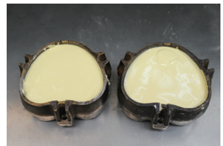
3-4 硬石こう「ニュープラストーンII」を用いた2次埋没。
