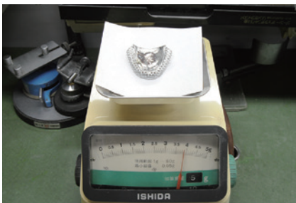
4-3 上顎メタルプレートの製作（金属床のメタルはDegdent社 Biosil F、出来上がり重量9g）。
