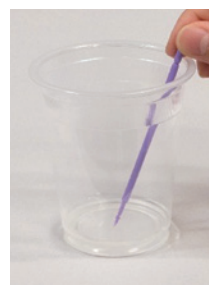
6-5 コップを軽く攪拌してろ液を均一にし、ろ液をブラシで採取する。
