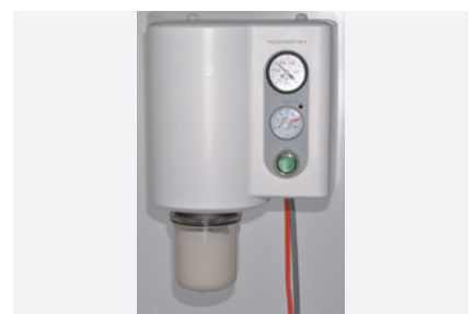
2-9 真空練和。真空練和器「バキュームミキサー-VM-Ⅱ」を使用して60秒間練和する。
