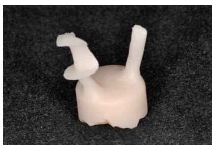
2-19 ガラスビーズのブラスト処理後の状態。ガラスビーズのみで反応層をほとんど除去できているのがわかる。
