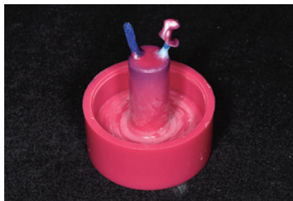
2-5 スプルーイング。スプルー植立方向は30度の角度をつけ、マージン部をリングの外側に向ける。特に単独の場合は反対側にダミースプルーを植立させプレス応力の安定を図ることでなめられるのを避ける。
