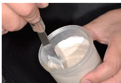
2-8 LiSi プレスベストの練和。真空埋没器のカップに計量した液、粉末の順番で入れ、手練和で約30秒間むらなく均一に練和する。
