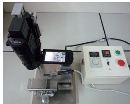
図2 エンドモーターを試験機に取り付け、破折までの時間を計測。
