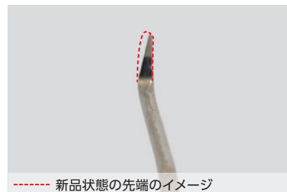
図9-2 GA13のシャープニング失敗例。GAタイプのキュレットはカットティングエッジの長さが1/2であるため、Gタイプ（ブレードの長さがスタンダード）よりさらに寿命が短くなる。
