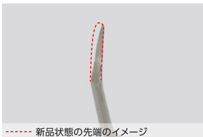
図9-1 G11のシャープニング失敗例。早い段階でトゥが尖り、インスツルメントを安全に使用できる寿命が短い。
