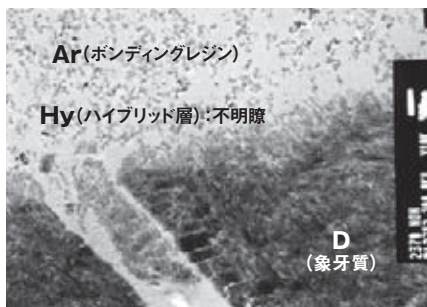
「G-ボンド プラス」の接着界面のTEM像(10,000倍)。従来のボンディング材にみられるハイブリッド層は不明瞭である。
