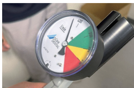
図15 HVE搭載のユニットは単独で420L/分（左写真）、4台同時稼働時でも、このユニットでは345L/分（右写真）と数値が出ているため、安心して診療することができる。
