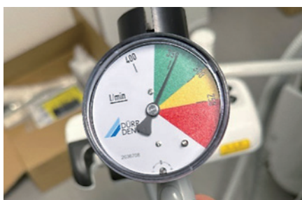
図15 HVE搭載のユニットは単独で420L/分（左写真）、4台同時稼働時でも、このユニットでは345L/分（右写真）と数値が出ているため、安心して診療することができる。
