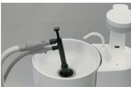
図10 当院ではオロカップ(デュールデンタル)を用いて管内の洗浄・消毒をしている。洗浄・消毒した薬液はそのまま排水溝に流れるので、作業者の手指や環境が汚染されない。もちろん、作業中のデンタルエアロゾルの曝露もまったくない。本来、「イオム 和」では写真に示すようにクリーニングアダプターを用いて管内の洗浄・消毒をする。薬液はオロトルプラスを使用する。
