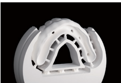
2-6 二次構造のジルコニアは、25mmのマルチレイヤーのジルコニアディスクからミリング。
