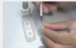
3.セラミックプライマーIIでシランカップリング処理し十分に乾燥
