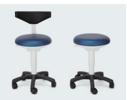
オペレーティングスツール OS-Ⅳ D/A <ドクター用> 外形寸法=458 (幅)×509 (奥行)×高さ (最高位) 862mm ●シート最高位=613mm ●シート最低位=460mm <アシスタント用> 外形寸法=458 (幅)×458 (奥行)×高さ (最高位) 613mm ●シート最高位=613mm ●シート最低位=460mm
