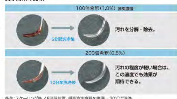
条件:スケーリング後、48時間放置。超音波洗浄器を使用し、20°Cで洗浄。
