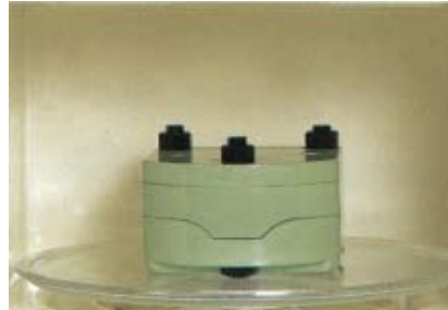
⑤ レジンの試圧を2-3回繰り返して行いバリを除去します。別売のフラスコガードの使用でフラスコの変形・破折が防げます。
