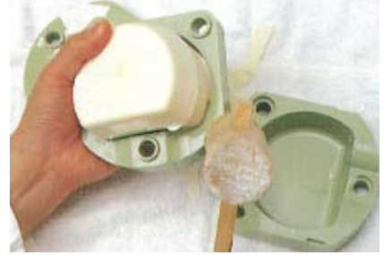
⑤ レジンの試圧を2-3回繰り返して行いバリを除去します。別売のフラスコガードの使用でフラスコの変形・破折が防げます。
