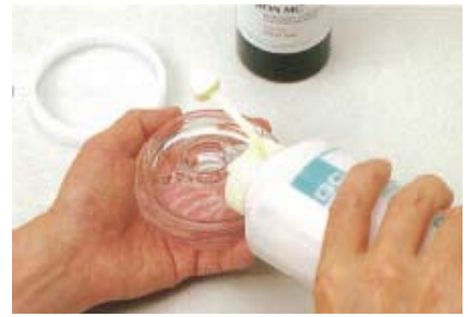
③ 粉末100g、液43mLの粉液比でアクロンMCを混和。23℃で約20分で填入可能な餅状になります。
