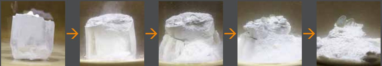
焼却後の鑄型を水中に浸漬し、崩壊性を確認。水に浸漬するだけでもスムーズに崩壊します。
