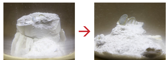
水中崩壊性試験:水に浸漬するだけでもスムーズに崩壊します。
