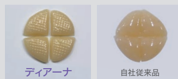
ペーストに網目模様と切れ目をつけ5分経過後の状態。ディアーナは、付与した形態が安定しています。
