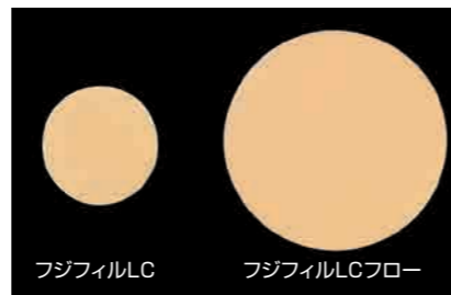
練和開始60秒後に120gの荷重をかけ、その広がり进行比较。(0.5mLのペーストで実施)
