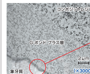
接着界面TEM像(脱灰処理後)
