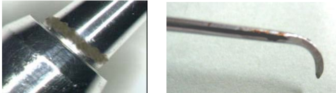
汚れが固着してしまった例
