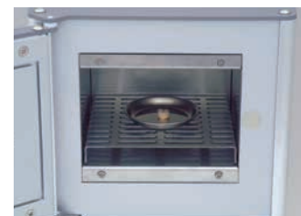
最終光重合後ブチオープンPO-IまたはラボキュアHLで110℃、15分加熱重合を行います。
