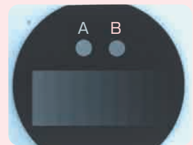
1mm厚円盤に成型したガターパーチャソフトポイントのX線造影性
