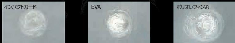
※鉄球落下試験結果:インパクトガードは鉄球を落とした時のシートの歪みが少なく、衝撃吸収能に優れています。
