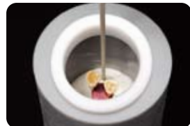
ワックスアップしたものをイニシャルプレスベストで埋没します。
