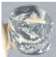
Ti ボンダー使用 セラミックスが 表面に残留 (凝集破壊)
