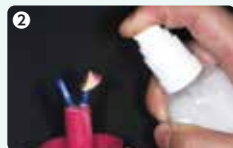
2 スプレーイングを行い界面活性剤 [SRリキッド] を一吹き、液だまりがないように弱圧エアで伸ばし乾燥。
