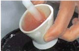
5 粉液を計量。10秒程なじませた後、気泡が入らないように静かに10-20秒混和。
