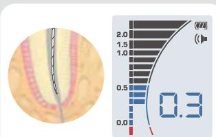
ファイル先端が根尖部付近に達するとバーグラフの色が青色に、同時にアラート音も変化することで、根尖孔に近づいていることをお知らせします。
