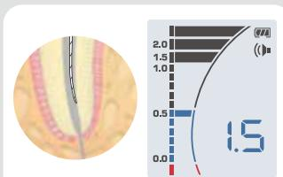
根管内へのファイル挿入と同時にバーグラフが表示され、ファイルの進行状況とバーの表示が連動します。
