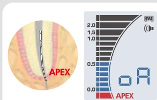
ファイル先端が根尖を越えた場合、赤いライン(APEX)の文字が表示されると同時に連続した速いアラート音でお知らせします。
