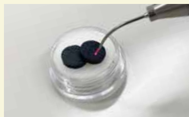
ファイバー先端に接触させながらレーザーを照射
