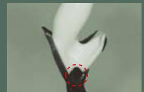
単に注入しただけでは先端部に気泡が混入しやすい。
